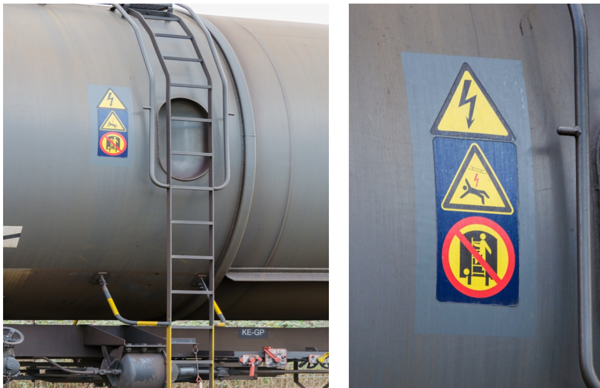
Abbildung 4: Warnhinweis Oberleitung an Fahrzeugen
