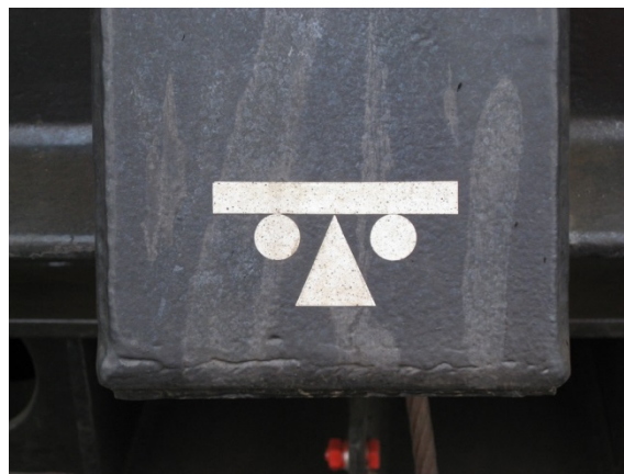
Abbildung 42: Ansetzpunkt zum Anheben
