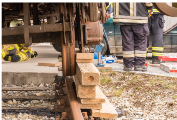
Abbildung 43: Sichern eines angehobenen Fahrzeugs durch Unterbau
