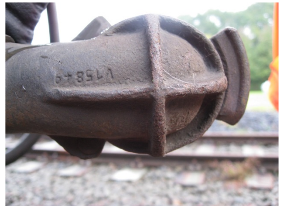
Abbildung 36: Gekennzeichneter Luftkopf einer Hauptluftbehälterleitung
