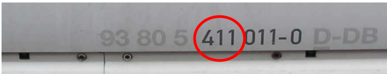
Abbildung 28: Zwölfstellige Fahrzeugnummer mit Baureihe
