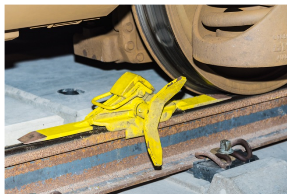
Abbildung 41: Radvorleger werden auf der Schiene befestigt
