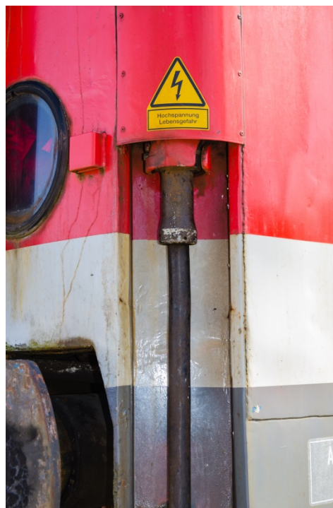
Abbildung 37: Nicht verbundene Zugsammelschiene an einem Reisezugwagen
