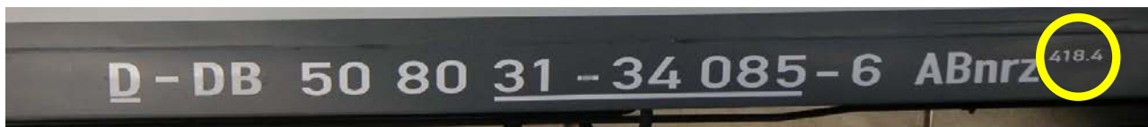
Abbildung 29: Zwölfstellige Fahrzeugnummer mit Bauartnummer
