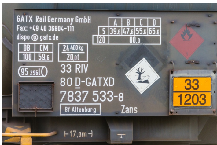
Abbildung 34: Anchriftentafel bei Kesselwagen mit Lastgrenzenraster und orangefarbener Kennzeichnung
