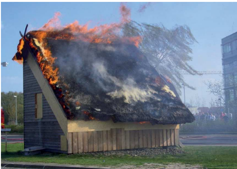
Abbildung 15 - Entweichen Wasserdampf aus den tieferen Reetschichten
